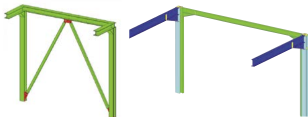
13 Po lewej: stężenia kratowe, po prawej: stężenia ramowe
